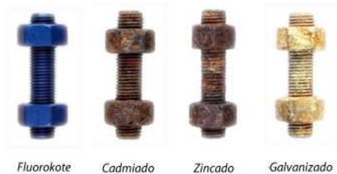
Ensayo ASTM B117, exposición a niebla salina
